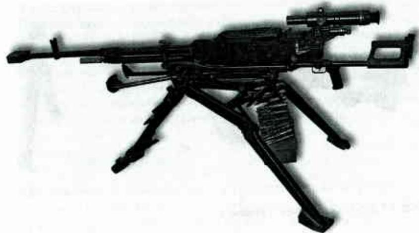
Рис. 70. Крупнокалиберный пулемет 6П50 Корд 12.7 на пехотном станке БТ7
